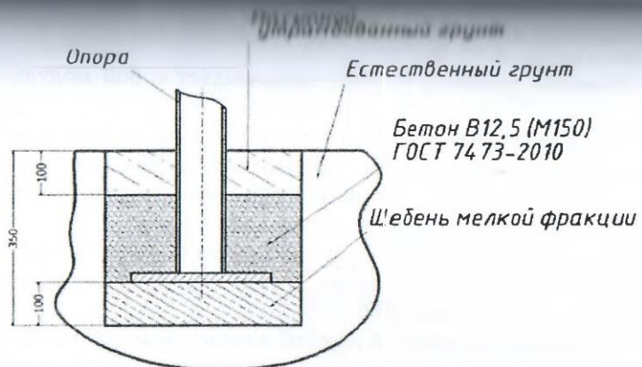
Рисунок 2 – Схема монтажа
