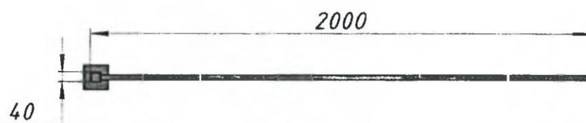
Рисунок 4а – Газонное ограждение (вид сверху)
