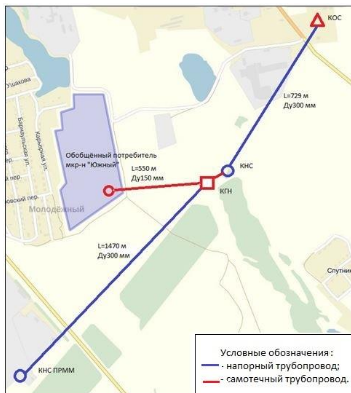
Рисунок 7 - Схема подключения самотечного коллектора Ду150 мм площадки перспективной жилой застройки микрорайона «Южный» в коллектор ПРММ.
